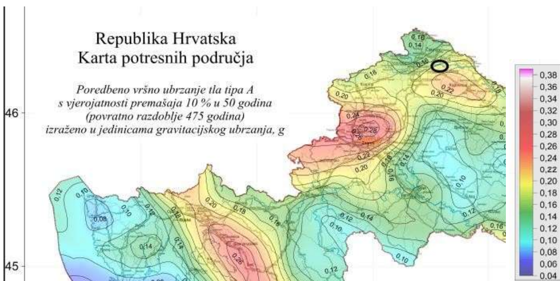
Slika 4: Izvod iz Karte potresnih područja u RH; Poredbeno vršno ubrzanje tla tipa A, povratno razdoblje 475 godina
